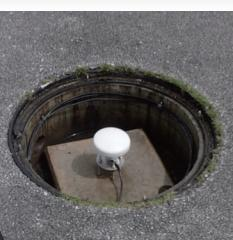
GPS センサー（堤体） GPS センサー（天端）
