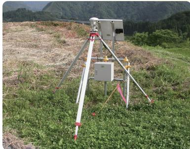
地すべりの変位傾向を三次元で連続的に計測
