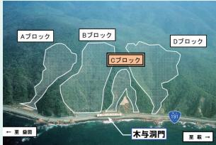
C ブロックは現在最も不安定な状況にあり、豪雨時の下部ブロックでの崩壊、それに誘発される上部ブロックの変動が懸念されている
